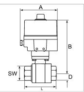
Положения включенияManually operatedКорпусAluminium, powder-coatedШаровой кранbrass nickel platedУплотнение шараPTFE, glass fibre-reinforcedШар, переключающий валChrome-plated brassСальниковое уплотнение<br/>переключенияFKMДополнительная информацияAufbauflansch ISO 5211
