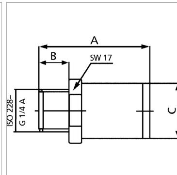
**Информация о продукте****Установочное давление** 8**A** 34 mm**макс.: расход** 420 l/min**B** 9,0 mm**SW** 17 mm**Ø C** 17 mm**Указания**
